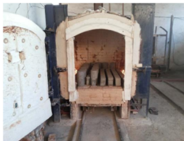
Gambar3. Proses paparan suhu tinggi balok beton bertulang di dalam tungku pembakaran keramik.
