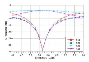
Fig. 9. S parameter 90° phase difference coupler
