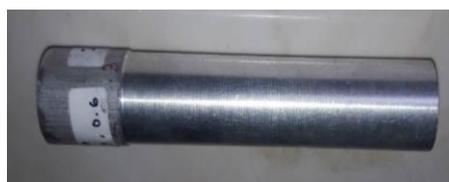
Gambar 4. Benda kerja bahan AA-6061 sebelum proses bubut
