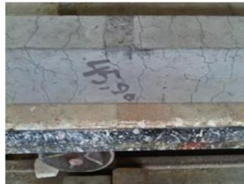
Gambar 4 Benda Uji setelah paparan suhu 600°C
