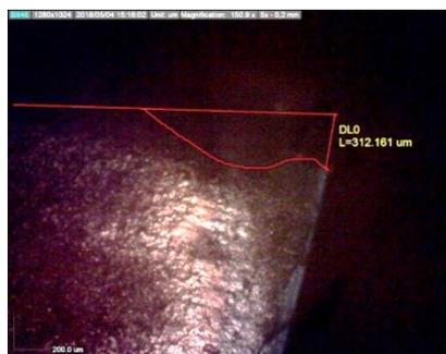
Gambar 13. Morfologi luasan area keausan tepi pada pahat no uji 10,  $V_B$  0.303 mm<sup>2</sup>
