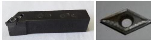
Gambar 6. Tool holder dan insert tool
