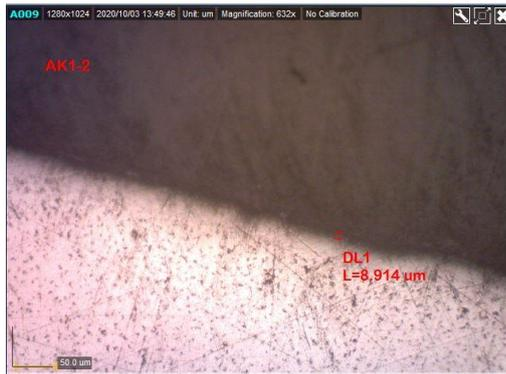
Gambar 5. Foto struktur mikro spesimen sprocket Kw 1 depan
