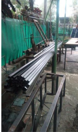
Gambar 8. Rangka Besi Kotak 2 x 2 cm
