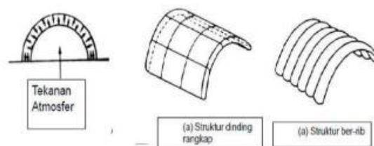
Gambar 1: Struktur Pneumatik yang Digelembungkan Udara (*Air Inflated*)
