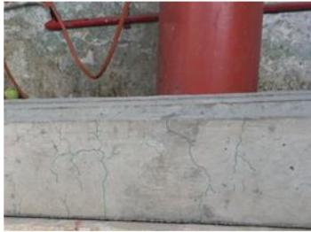
Gambar 3 Benda Uji setelah paparan suhu 400°C
