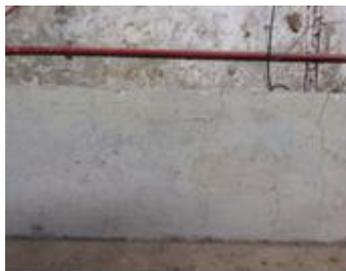
Gambar 5 Benda Uji setelah paparan suhu 800°C
