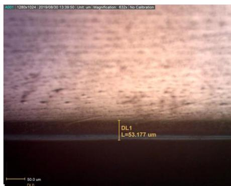
Gambar 7. Foto struktur mikro spesimen baja ST37
