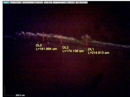
Gambar 15. Morfologi tebal geram setelah terpotong pada pahat no uji 11 hc 0.183 mm
