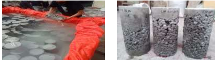
Gambar 4. 11 Proses Mengeluarkan Benda Uji Dari Bak Perendaman
