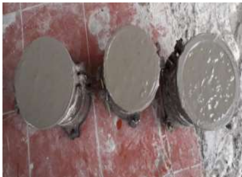
Gambar 4. 7 Ratakan Permukaan Silinder Dengan Cetokan
