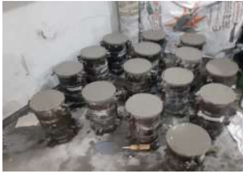
Gambar 4. 8 Diamkan Silinder Beton Selama 1 Hari
