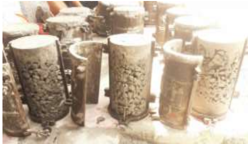
Gambar 4. 9 Proses Pembongkaran Cetakan Silinder
