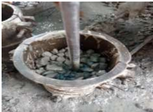
Gambar 4. 6 Proses Pemadatan Campuran Beton Didalam Silinder
