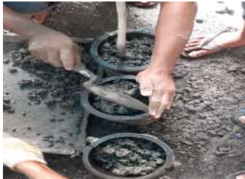
Gambar 4. 5 Masukan Campuran Beton Kedalam Silinder
