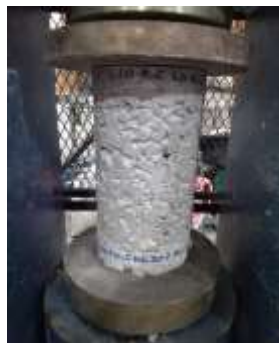
Gambar 4. 12 perletakan Benda Uji Silinder Beton Pada CTM
