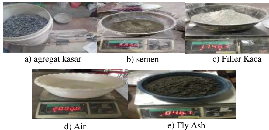
Gambar 4. 1 Menimbang Material Agregat Kasar, Semen, Filler Kaca, Air Dan Fly Ash
