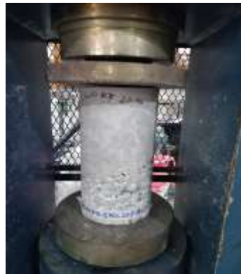
Gambar LII.6 Pengujian Kuat Tekan Beton Non Pasir
