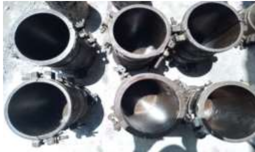
Gambar 4. 2 Menyiapkan Cetakan Silinder
