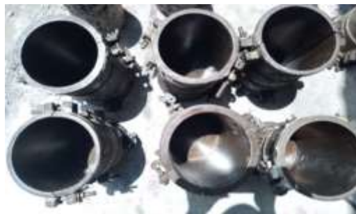
Gambar LII.2 Penyiapan Silinder Beton Non Pasir Yang Diolesi Minyak Pelumas
