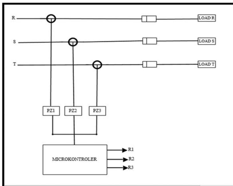
Gambar 4. Skematik rangkaian alat
