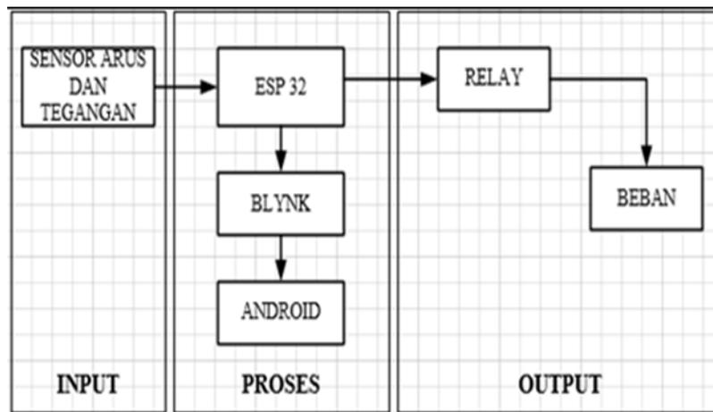
Gambar 1. Diagram blok
