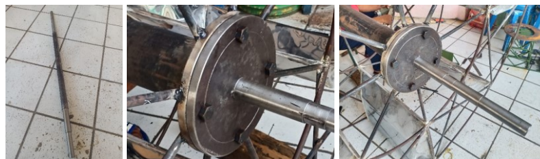
Gambar 13. Pemasangan inner flange , poros bertingkat, dan pasak pada outer flange
