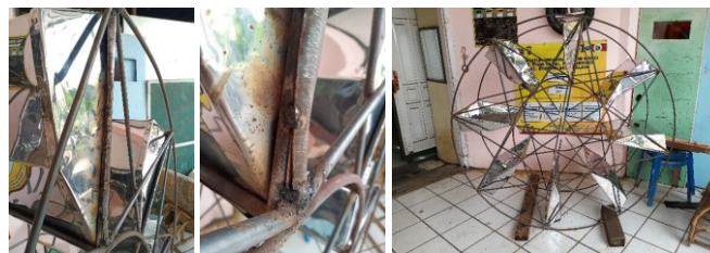
Gambar 10. Tahapan pemasangan sudu ( blade )
