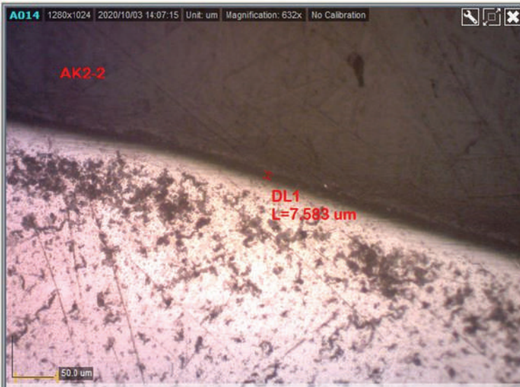
Gambar 23. Foto struktur mikro spesimen sprocket KW 2 depan
