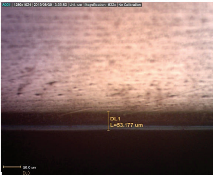
Gambar 24. Foto struktur mikro spesimen baja ST37
