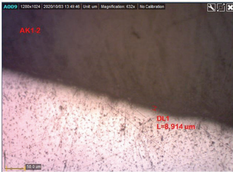
Gambar 22. Foto struktur mikro spesimen sprocket KW 1 depan
