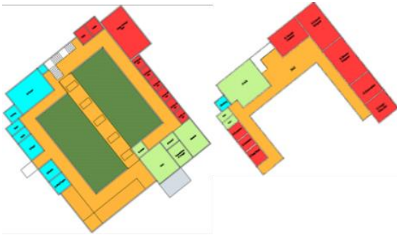
Gambar 3. Organisasi massa berdasarkan area: publik (biru); transisi (kuning); sensorik (merah); layanan (hijau)
