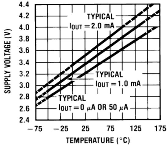
Gambar 2 Resistansi Tegangan terhadap Temperatur [7]
