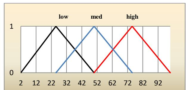
Gambar 4 Fungsi Keanggotaan Variabel Input Konsentrasi Gas LPG
