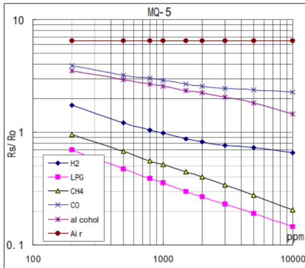
Gambar 1a Resistansi MQ5 terhadap Konsentrasi Gas LPG [6]
