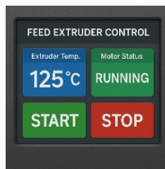
Gambar 5.19 Ilustrasi skematik panel interface sistem kontrol mesin cetak pakan.
