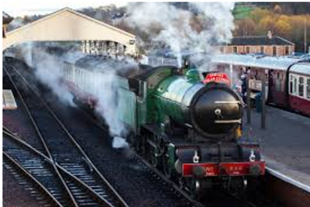
Gambar 2.2 Mesin pembakaran luar.
