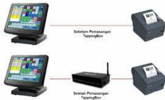
Gambar 1.2 Peletakan tapping box
