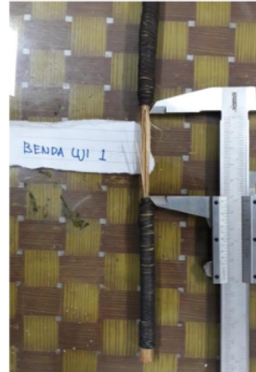
Gambar 4. 1 Uji tarik Tulangan Bambu
