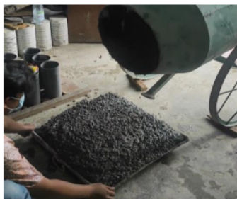
Gambar 4. 4 Campuran Beton yang dituang ke Bak
