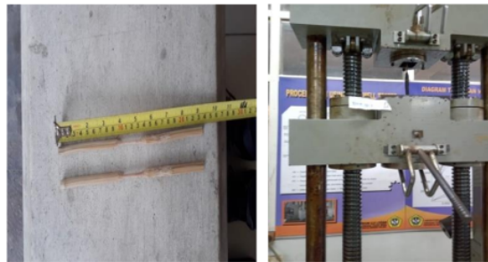
Gambar 3. 10 Uji Kuat Tarik Bambu
