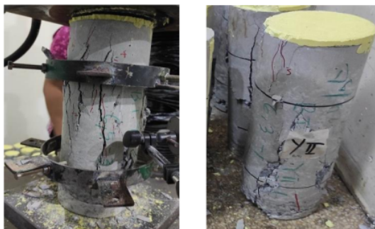
Gambar 4. 22 Pola Retak pada BTTB.Fy2 (tegangan leleh Fy2)
