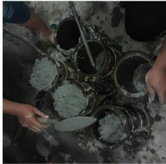
Gambar 4. 6 Pemadatan bagian beton pada silinder
