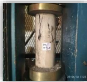
Gambar 4. 17 Uji Benda Uji Silinder Pada Alat Uji Tekan Silinder (CTM)
