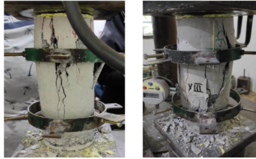
Gambar 4. 23 Pola Retak pada BTTB.Fy3 (tegangan leleh Fy3)
