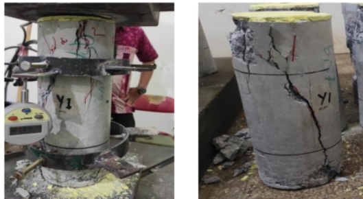
Gambar 4. 21 Pola Retak pada BTTB.Fy1(tegangan leleh Fy1)
