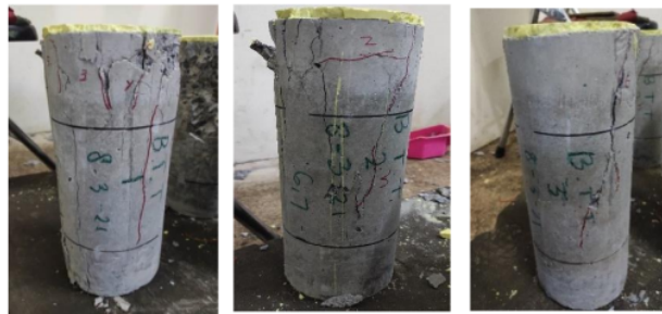
Gambar 4. 18 Pola Retak Pada Benda Uji BTT
