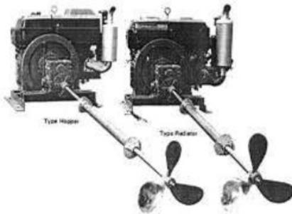
Gambar 7. Motor Diesel Sebagai Penggerak Baling-Baling
