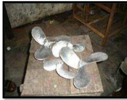
Gambar 6. Hasil Cor Baling-Baling Kapal Nelayan Setelah Proses Pemeriksaan Visualisasi
