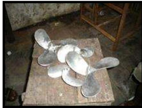
Gambar 6. Hasil Cor Baling-Baling Kapal Nelayan Setelah Proses Pemeriksaan Visualisasi
