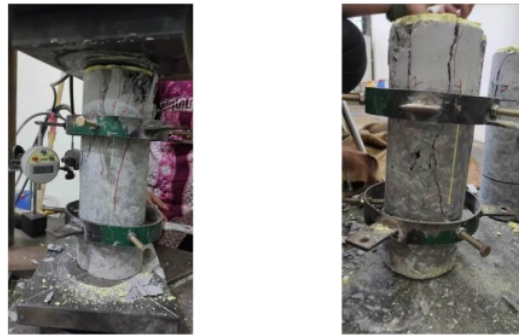
Gambar 4.24 Pola Retak pada BT.S20 (spacing 20 mm.)
