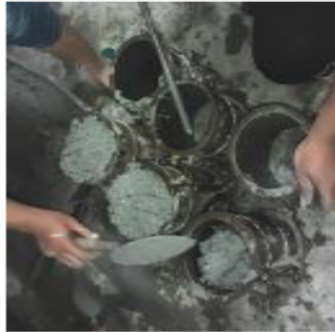
Gambar 4.6 Pemadatan bagian beton pada silinder
