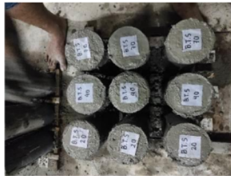
Gambar 4.18 Beton Mengeras 24 Jam
