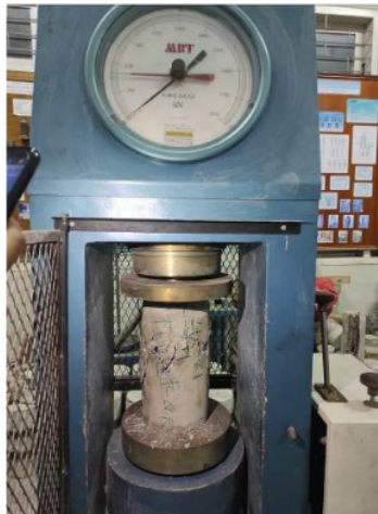
Gambar 4.20 Pengujian Benda Uji Silinder Pada Alat Uji Tekan Silinder (CTM)
