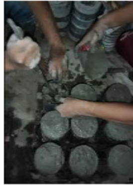
Gambar 4.17 Pemasukan Campuran Beton Pada Bekisting Beton Terkekang
