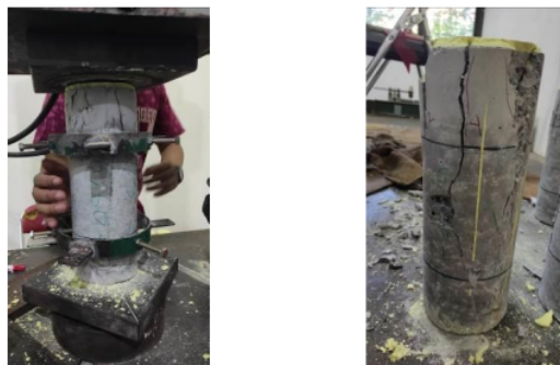
Gambar 4.25 Pola Retak pada BT.S40 (spacing 40 mm.)
