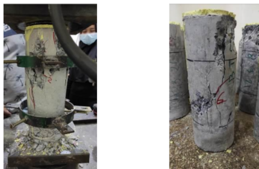
Gambar 4.26 Pola Retak pada BT.S70 (spacing 70 mm.)
