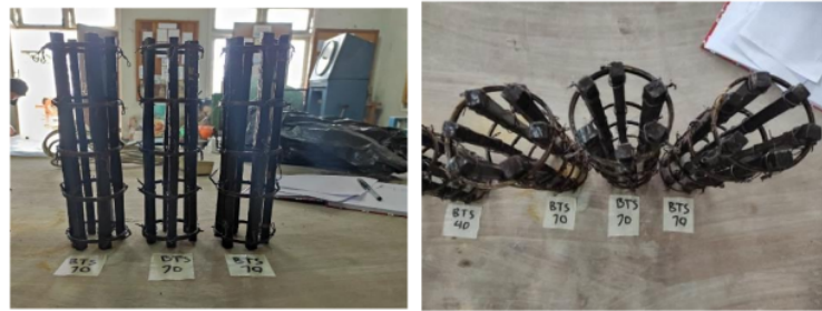
Gambar 4.10 Tulangan Bambu Yang Telah Difabrikasi
