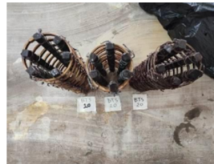
Gambar 4.9 Fabrikasi Tulangan Bambu
