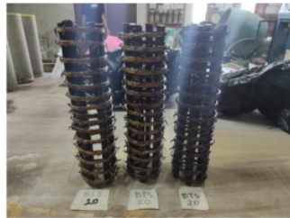
Gambar 4.9 Fabrikasi Tulangan Bambu
