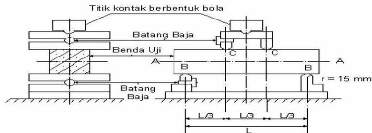
Gambar 2. 8 Pengujian Momen Lentur Pada Balok
