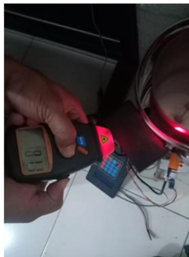
Gambar 9. Foto pembacaan menggunakan Tachometer
