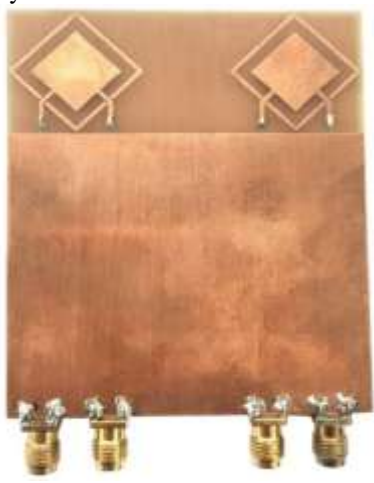
Gambar 3. Implementasi prototipe Antena Mikrostrip Margin Persegi Ganda
