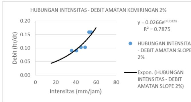
Gambar 5. Hubungan Intensitas - Debit Amatan pada Kemiringan 2%
