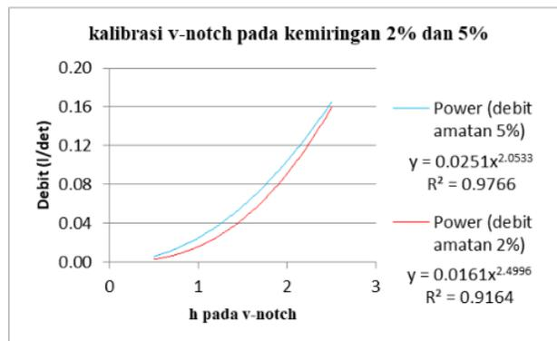
Gambar 3. Kalibrasi V-Notch Kemiringan 2% Dan 5%
