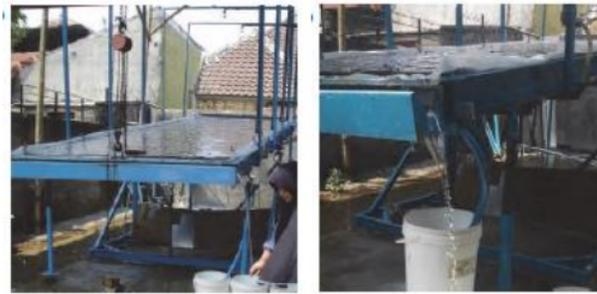
Gambar 1. Alat Uji Simulator Hujan
