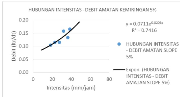
Gambar 6. Hubungan Intensitas – Debit Amatan Kemiringan 5%
