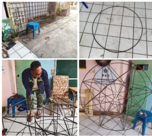
Gambar 7. Tahapan pembuatan frame kincir
