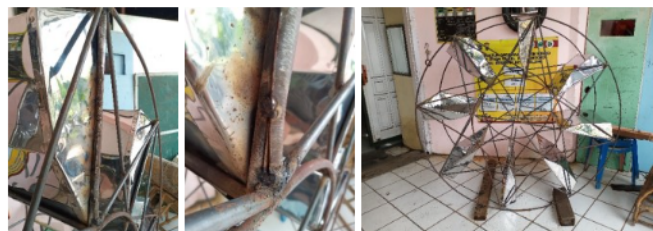
Gambar 10. Tahapan pemasangan sudu ( blade )
