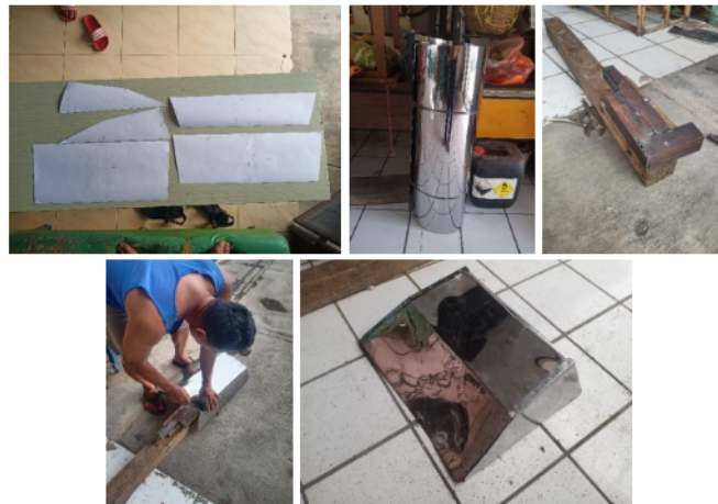
Gambar 9. Tahapan pembuatan sudu ( blade )
