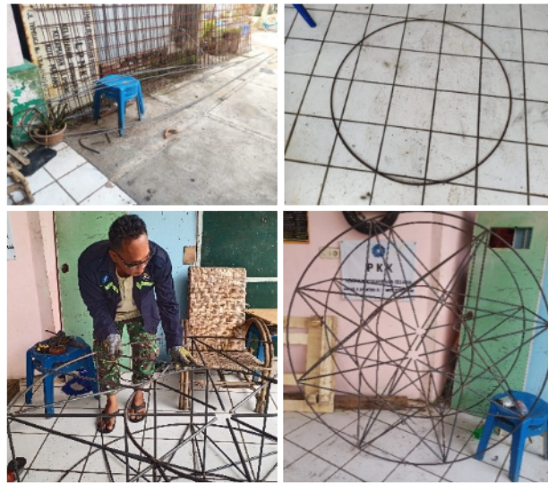
Gambar 7. Tahapan pembuatan frame kincir
