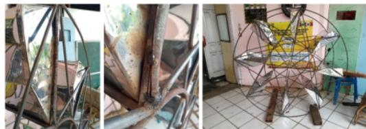
**Gambar 10.** Tahapan pemasangan sudu (*blade*)
