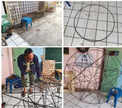
**Gambar 7.** Tahapan pembuatan *frame* kincir
