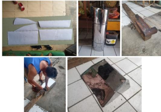
**Gambar 9.** Tahapan pembuatan sudu (*blade*)
