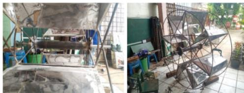
**Gambar 14.** Hasil akhir proses *assembly* komponen-komponen kincir air
