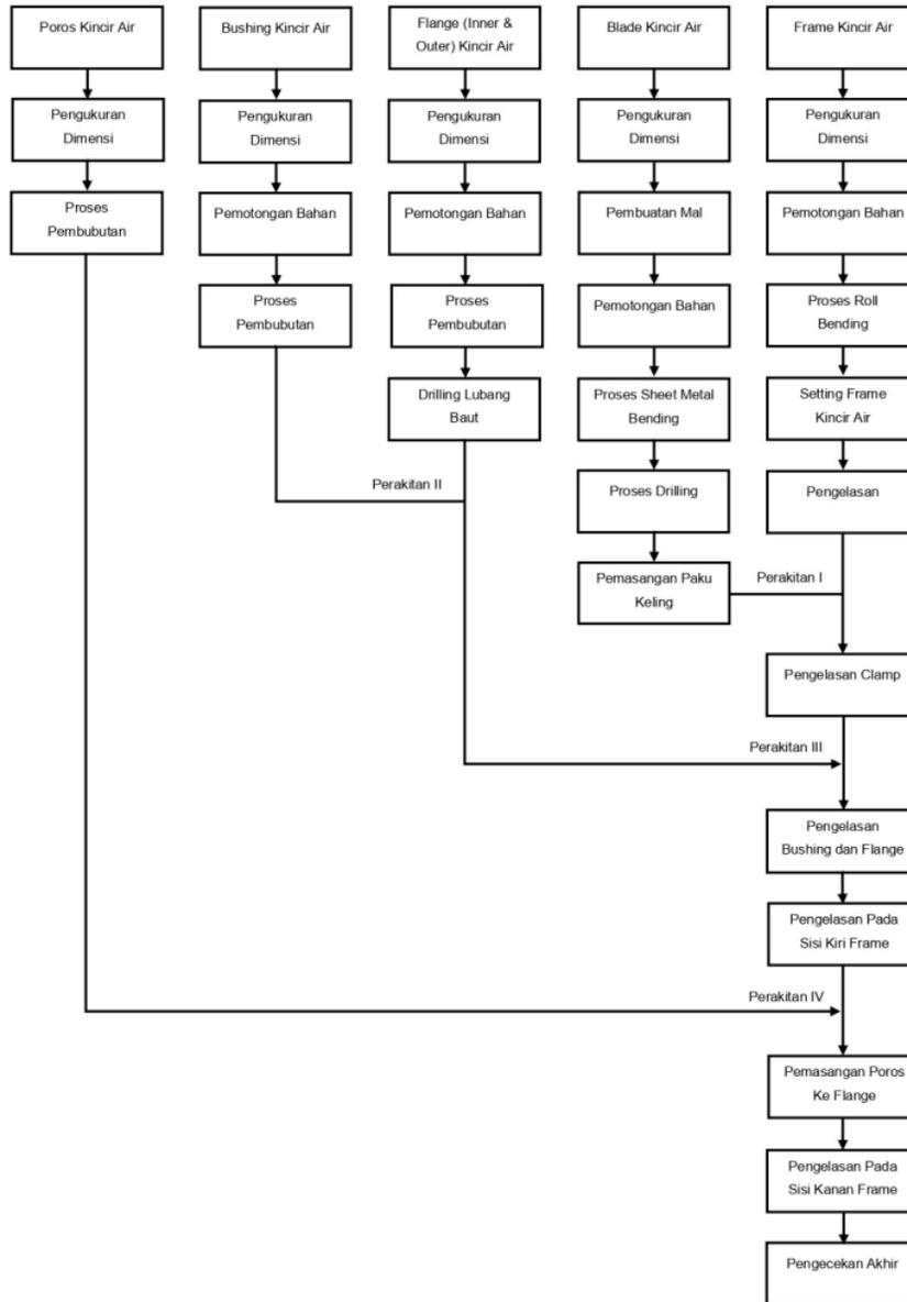
Gambar 5. Diagram alir proses pembuatan kincir air
