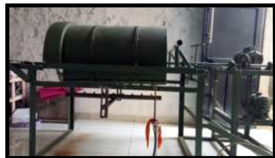
Gambar 5. Mesin sangrai kopi menggunakan motor listrik 1 pk untuk memutar tabung sangrai dan pemanasan menggunakan kompor elpiji, yang dilengkapi tutup penahan panas.
