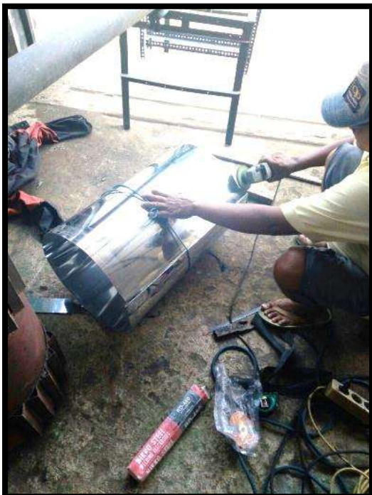
Gambar 3. Pembuatan tabung sangrai
