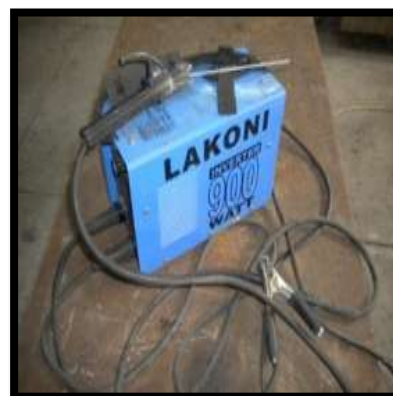
Gambar 8. Mesin Las Busur Listrik Elektroda Terbungkus
