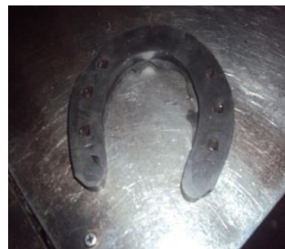
Gambar 4. Hasil Modifikasi Sepatu Kuda Setelah Di Lapisi Karet (Sebelum Dilakukan Finishing )
