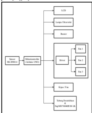
Gambar 1. Blok Diagram Alat
