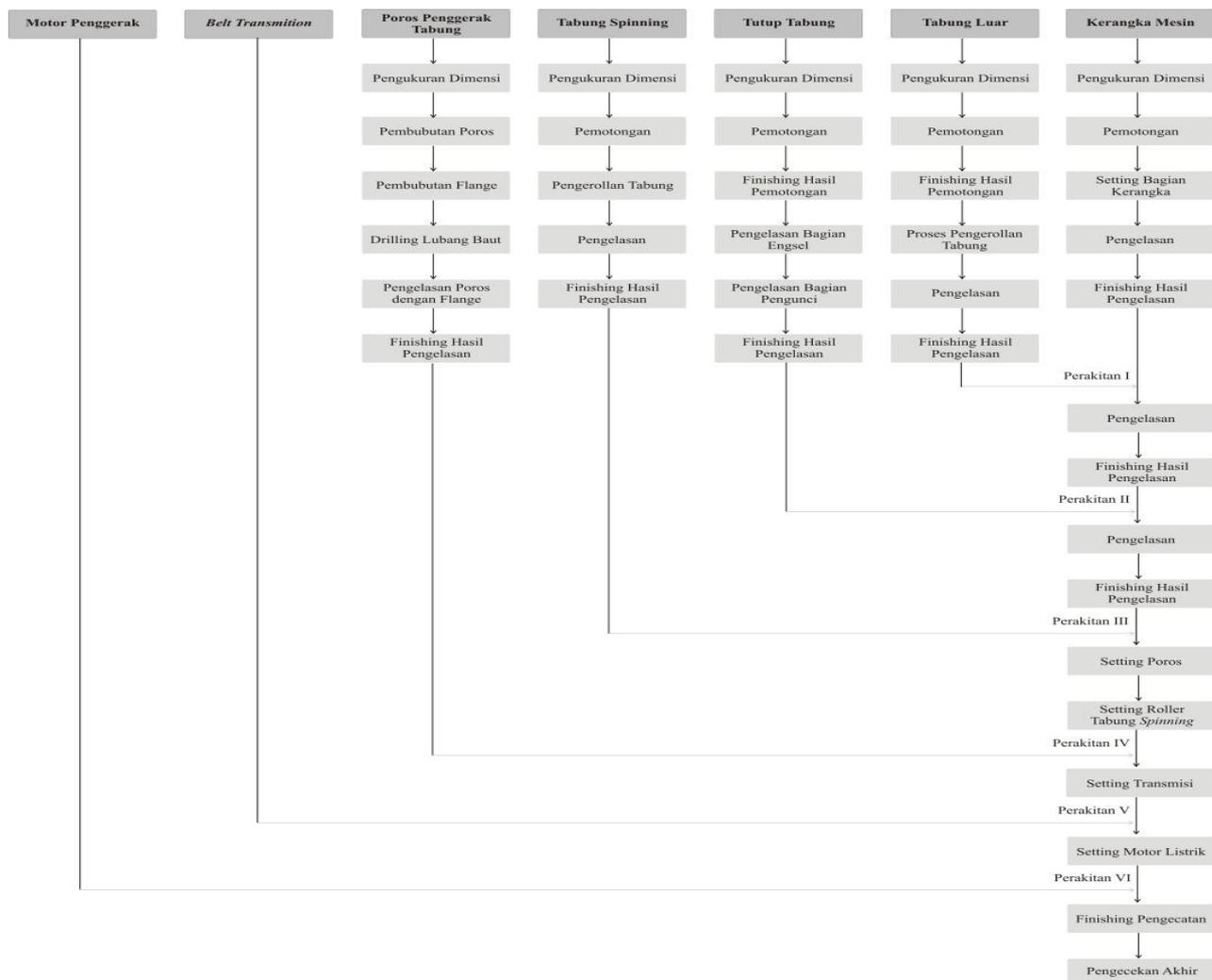
Gambar 5. Analisa Proses Pembuatan Komponen Mesin *Spinning Carpet*
